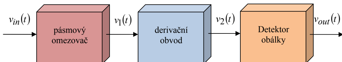
Obr. 5.9.1. Schéma derivačního detektoru FM signálu
